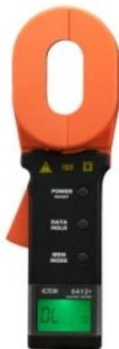
VICTOR6412 + ЗАЖИМНЫЙ ПРИБОР ДЛЯ ИСПЫТАНИЯ СОПРОТИВЛЕНИЯ ЗАЗЕМЛЕНИЯ
