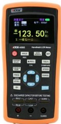
**4080 портативный измеритель LCR высокой точности многофункциональный измеритель сопротивления индуктивности емкости с USB-тестером**
